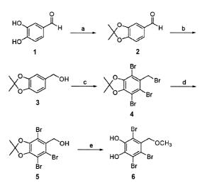
Scheme 1. Reaction conditions; a) Acetone,  $P_2O_5$ , toluene; b) DIBAL-hexane,  $CH_2Cl_2$ , -78 °C; c)  $Br_2$ , conc. HCl,  $H_2O$ ; d) CaCO<sub>3</sub>,  $H_2O$ , dioxane; e) conc. HCl, MeOH.
